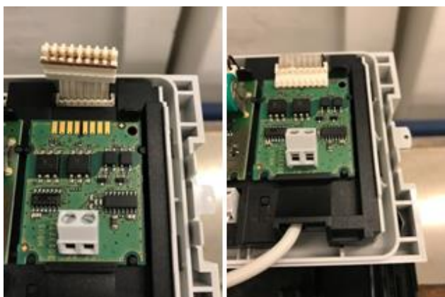
Figur 12: Montera M-Buskortet och anslut anslutningskontakten till M-Buskortet
