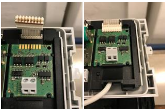
Figur 12: Montera M-Buskortet och anslut anslutningskontakten till M-Buskortet
