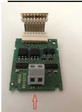
Figur 10: Anslutning plint 24,25 på M-Buskortet
