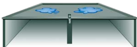
Befintlig brunn och verkliga lågpunkter
